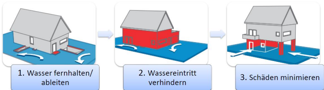
Abbildung 23: Hochwasser- / Starkregenangepasste Bauweise
