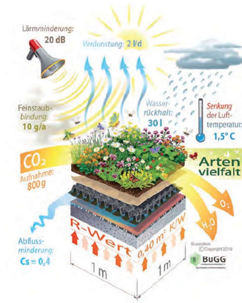
Abb. 7: Ein Quadratmeter Dachbegrünung vereint viele positive Wirkungen. Quelle: BuGG
